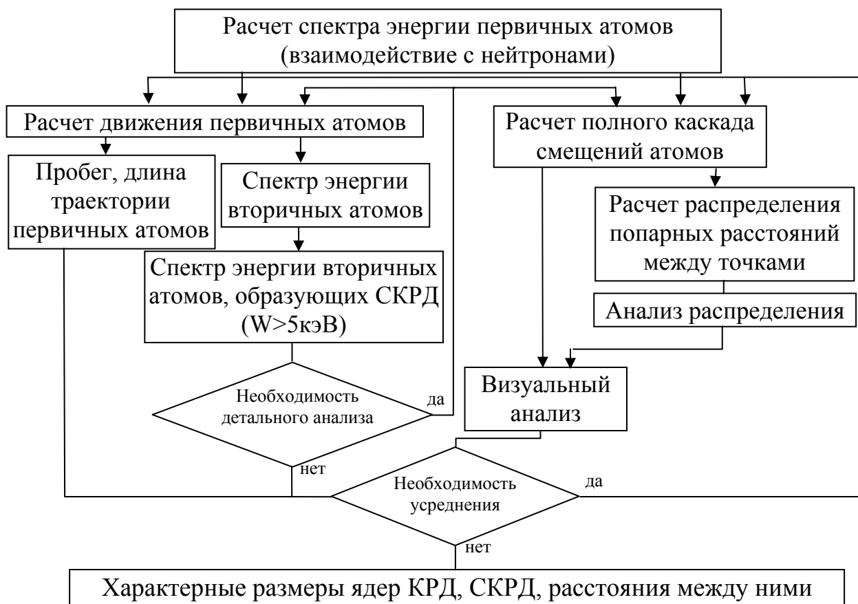
Рис. 29. Общая схема анализа топологии КРД в полупроводниках и полупроводниковых приборах
